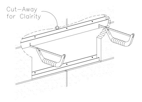
WITH HEAVY PLIERS, GRASP THE LOWER FLANGE NEXT TO THE VERTICAL CUT AND TWIST. THIS WILL SHEAR THE FLANGE FROM THE EXTRUSION.
